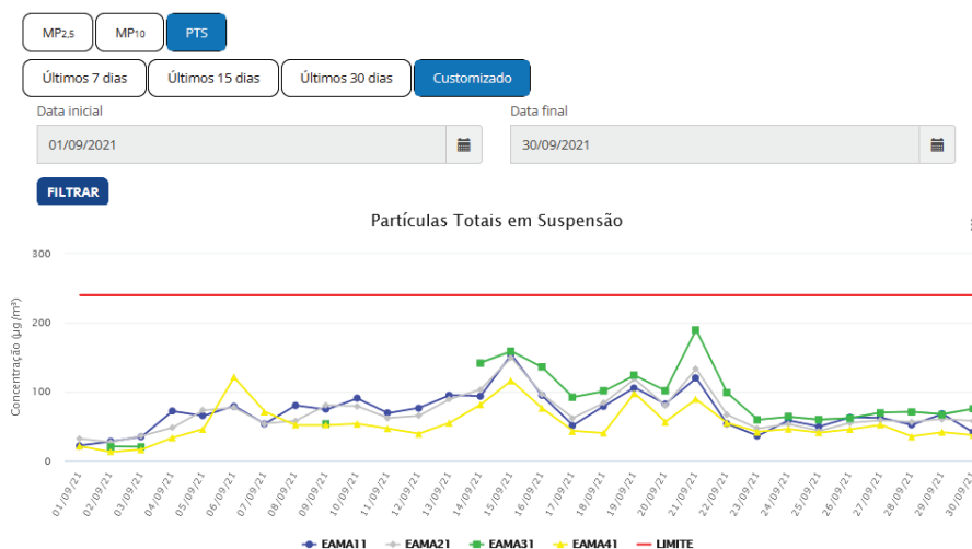
Figura 20. Concentração ( \mu\text{g}/\text{m}^3 ) do PTS para as 4 estações de monitoramento em Itabira no período de 1 a 30 de setembro de 2021.
